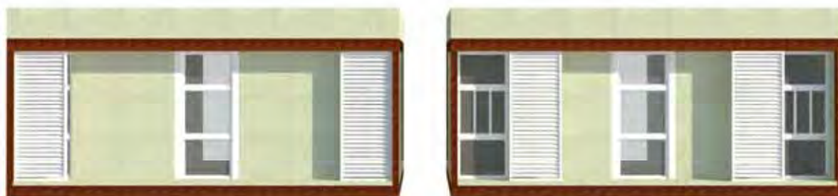
Figura 47. Vista externa de um módulo: à esquerda, o painel de PVC fechado e, à direita, aberto. 2012.
