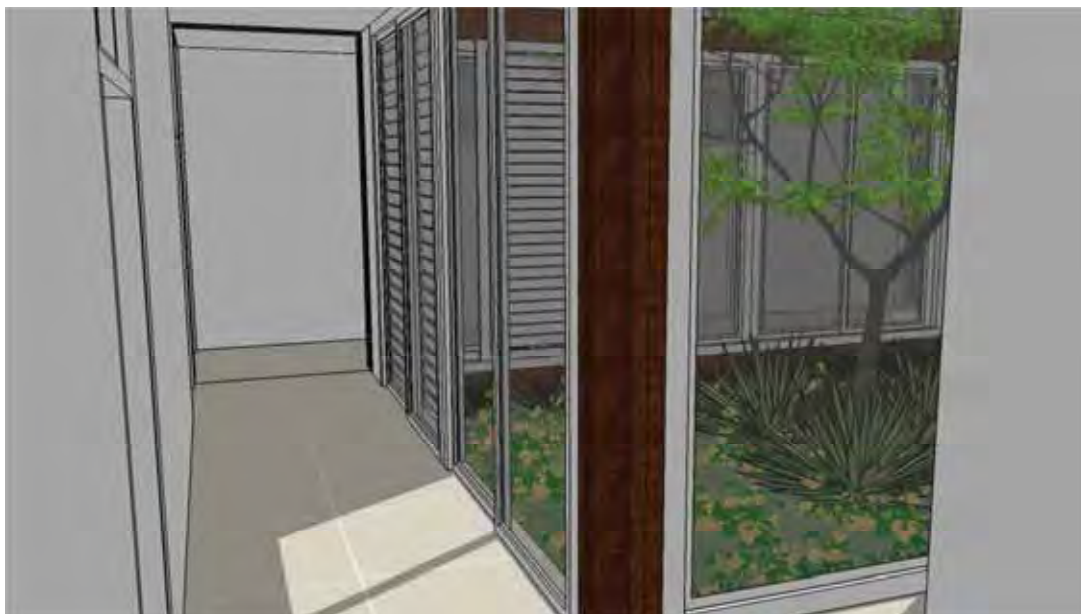
Figura 48. Vista interna da unidade, mostrando a incidência solar com e sem a proteção dos painéis de PVC . 2012.
