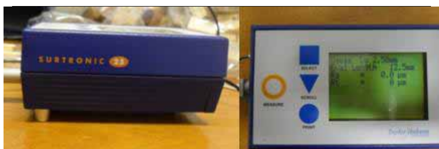
Figura 47. Rugosímetro Modelo SURTRONIC 25+; marca TAYLOR HOBSON.
