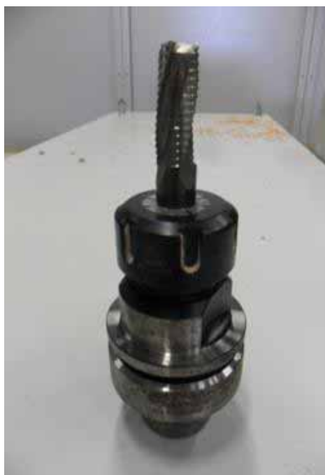
Figura 45. Fresa de desbaste (Fabricante: CMT).
