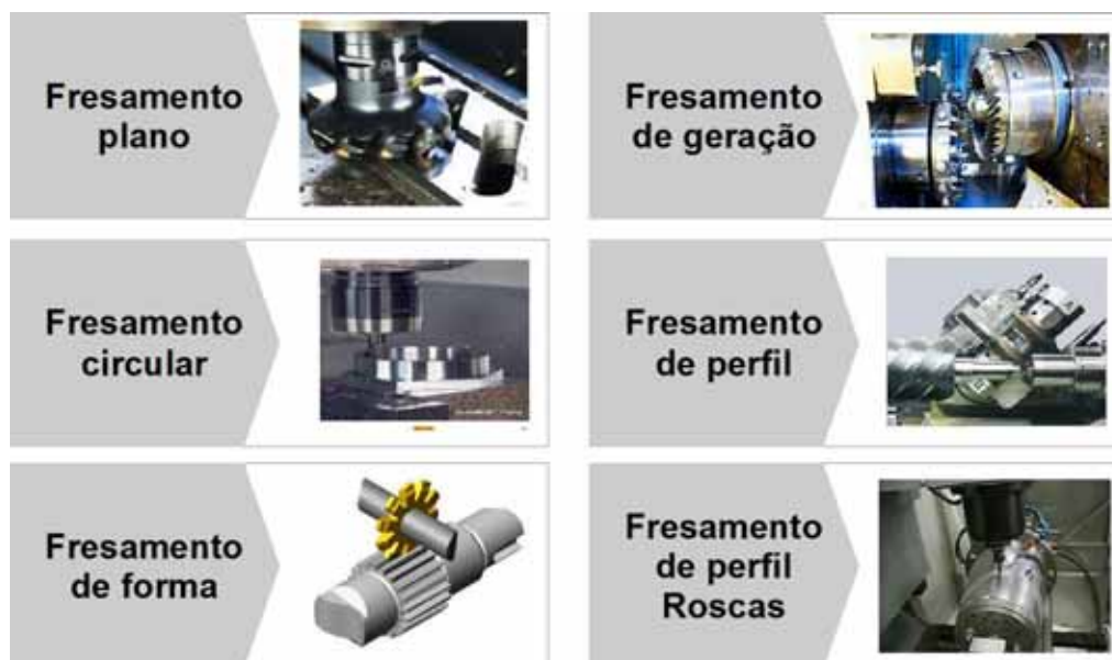
Figura 1. Tipos de Fresamento (STOETERAU, Acesso em: 11 mar. 2013).
