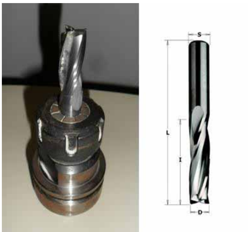
Figura 46. Fresa de acabamento (Fabricante: CMT).
