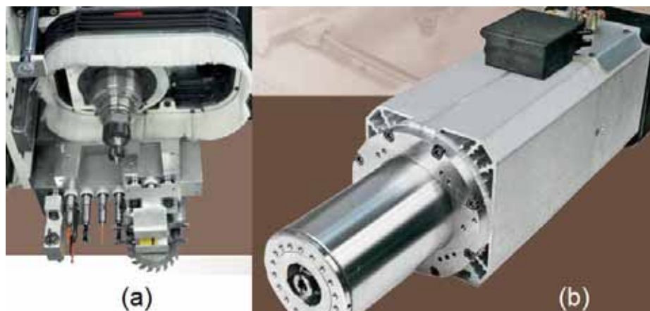
Figura 30. (a) Unidade de operação e (b) Mandril (Catálogo TECH Z1 2011- adaptado).
