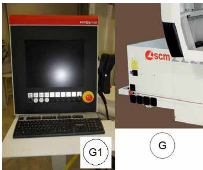
Figura 29. Armário elétrico G e painel de controle móvel G1 (Catálogo TECH Z1 2011- adaptado).
