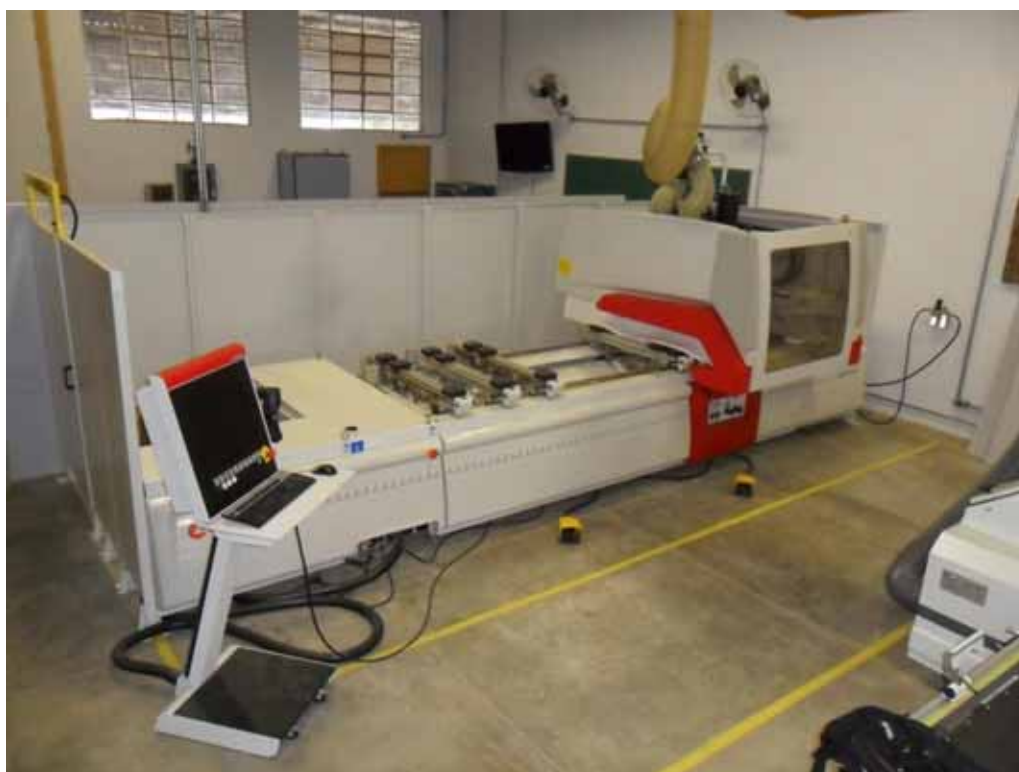
Figura 41. Furadeira – Fresadora CNC Tech Z1 (SCM GROUP S.P.A – Manual de Instruções, 2011).
