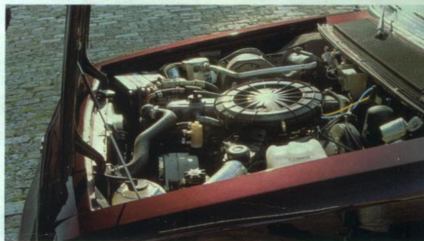
O motor 4.1: no futuro, injeção eletrônica e 24 válvulas
