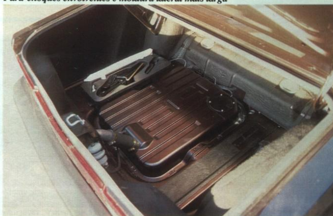
Porta-malas espaçoso e um imenso tanque com capacidade para 91 litros
