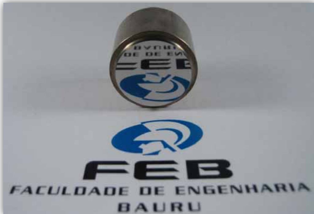
FIGURA 4.30 – Acabamento espelhado do aço ABNT 420 temperado e revenido (45 HRc) após a operação de lapidoretificação (rebolo de 800 mesh, U_d = 5 , a_d = 0,1 , P = 150 kPa e emulsão aplicada com MQF - ensaio 17).
