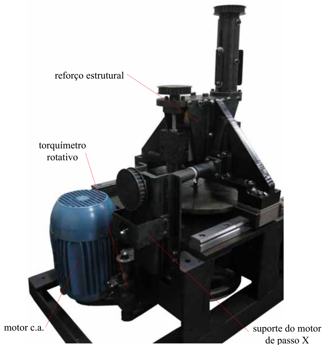
FIGURA 3.22 – Estrutura da lapidoretificadora: 6ª etapa da montagem.
