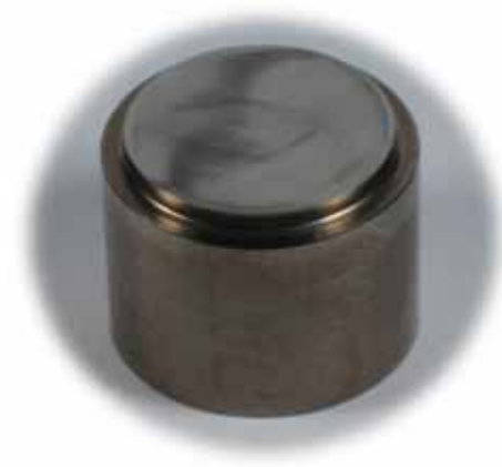
FIGURA 3.34 – Corpo-de-prova após 10 minutos de lapidoretificação ( R_a = 33,9 nm) com a_d = 0,1 mm, U_d = 3 , granulometria de 800 mesh, P = 150 kPa e óleo aplicado com MQF.
