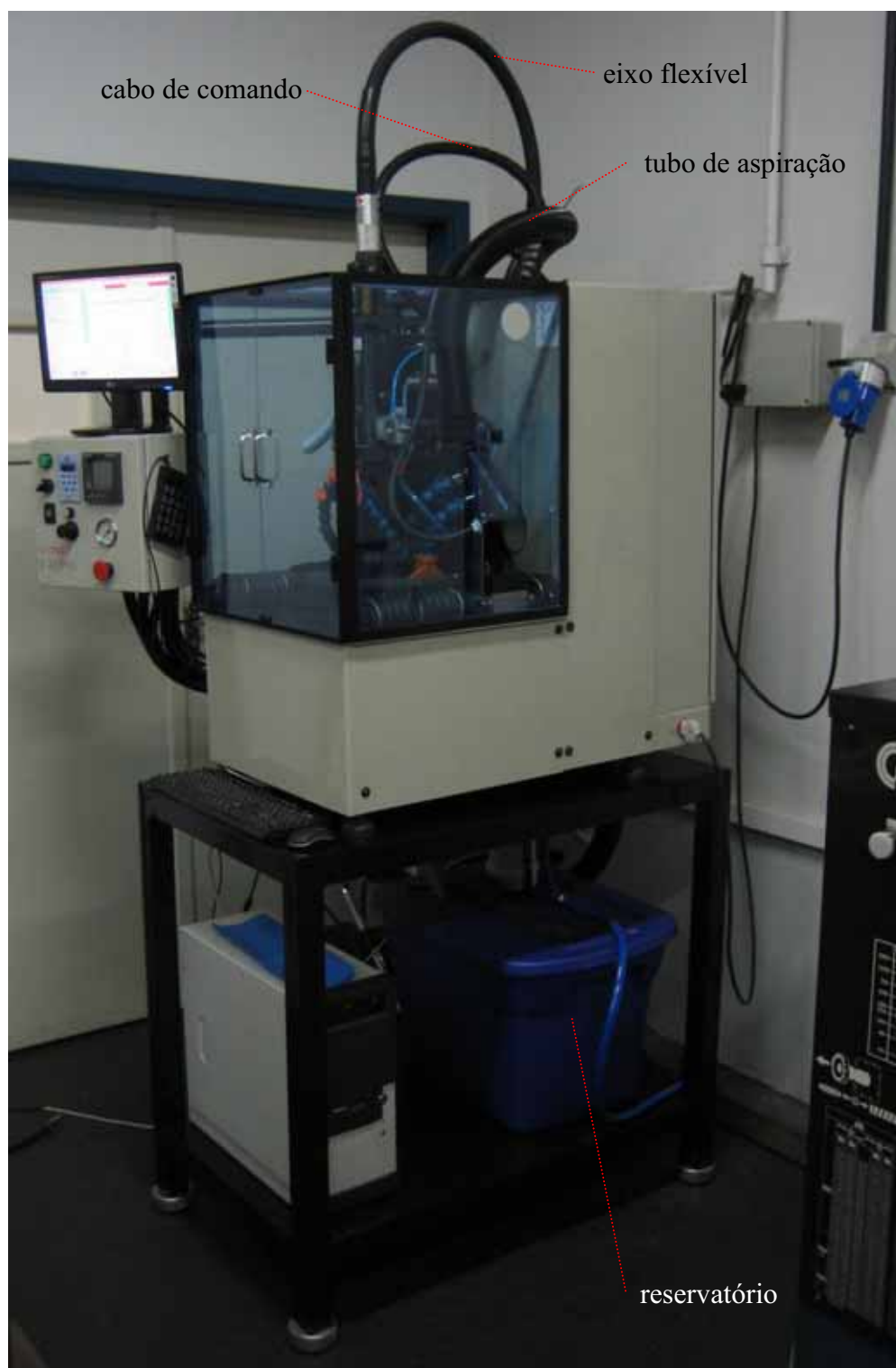
FIGURA 3.27 – Aspecto final da lapidoretificadora vista em perspectiva.
