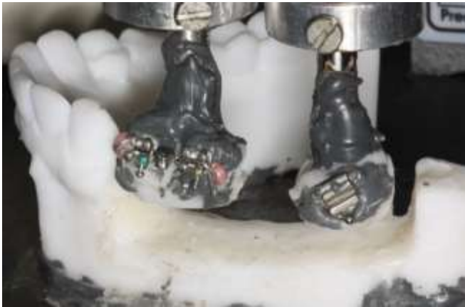
Fixação dos sensores e remoção da cera pegajosa
