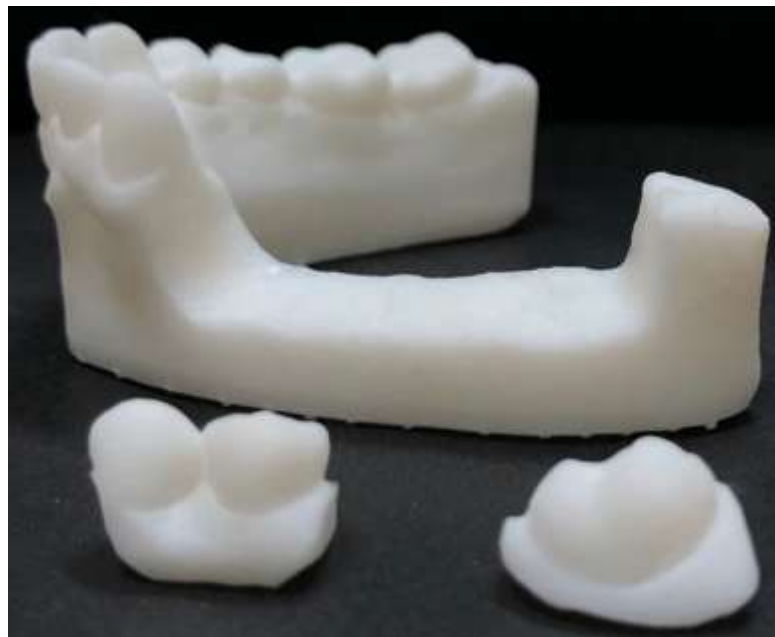
Figura 2: Coroas dentais impressas separadamente.
