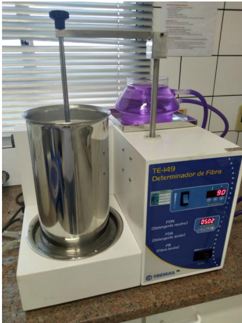
Foto 2 – Aparelho TE – I49 Determinador de Fibra
