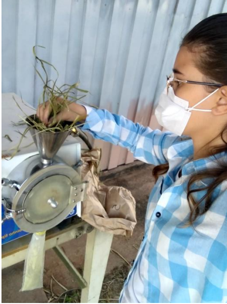
Foto 5 – Moagem da parte aérea após secagem em estufa.
