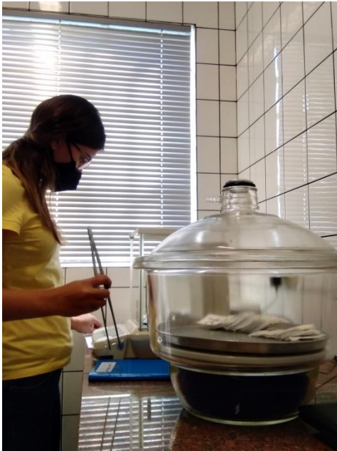
Foto 3 – Pesagem de saquinho para amostra de matéria seca
