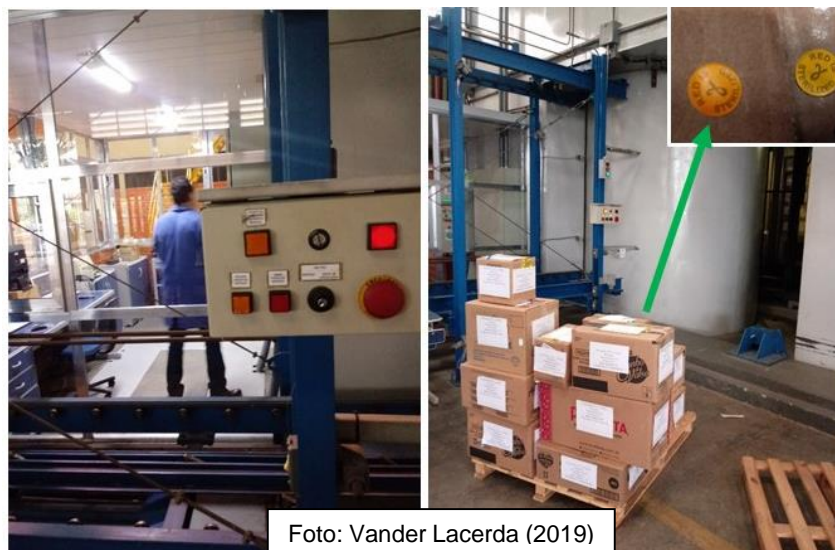
Figura 4 - Configuração do irradiador para cada dose requerida, e as caixas com adesivo indicador químico gama garantindo que os frutos receberam a irradiação.
