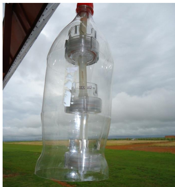
Figura 12 - Bomba de vácuo e “filter packs” com os filtros dispostos em série para amostragem de MP e fase gasosa.
