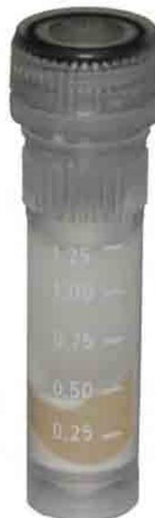
FIGURA 2 – Adição de 1000  $\mu$ l de metanol.
