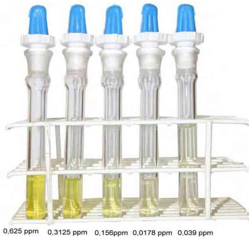
FIGURA 11 – Balões volumétricos de 2,0 ml contendo diferentes diluições da solução padrão.
