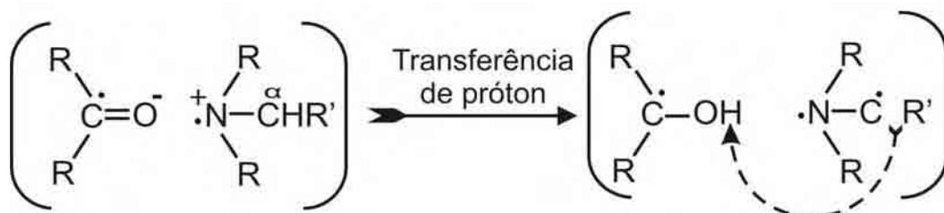
FIGURA 14 – Transferência da amina para a cetona.
