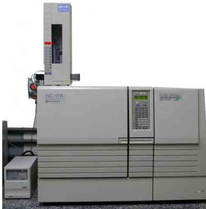
FIGURA 7 – Cromatógrafo Shimadzu GC-17A acoplado ao espectrômetro de massa QP5050.
