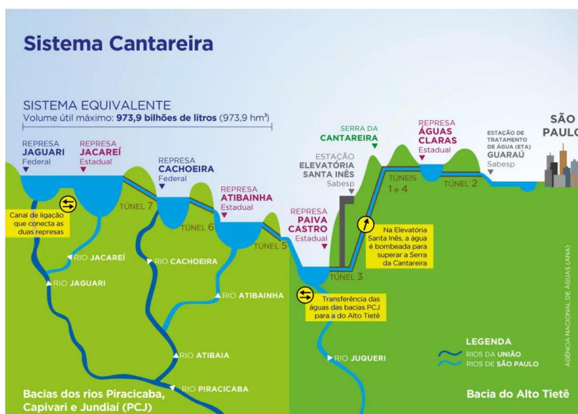
Figura 1 - Estrutura de funcionamento do Sistema Cantareira.
