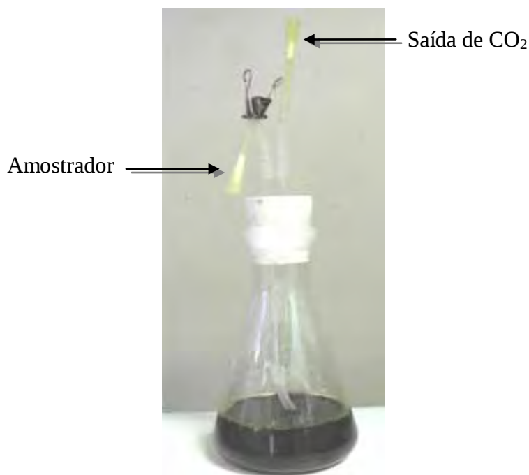
Figura 5. Sistema utilizado nas fermentações em batelada simples, conforme sugerido por Trevisan H. C. (SOUZA et al. , 2007).
