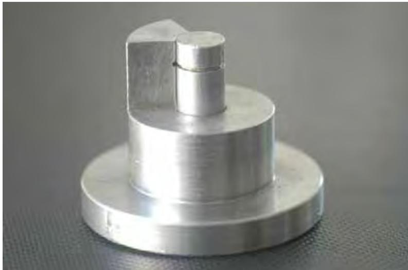
FIGURA 4 - Conjunto arco mais cilindro guia, compondo o canal artificial.
