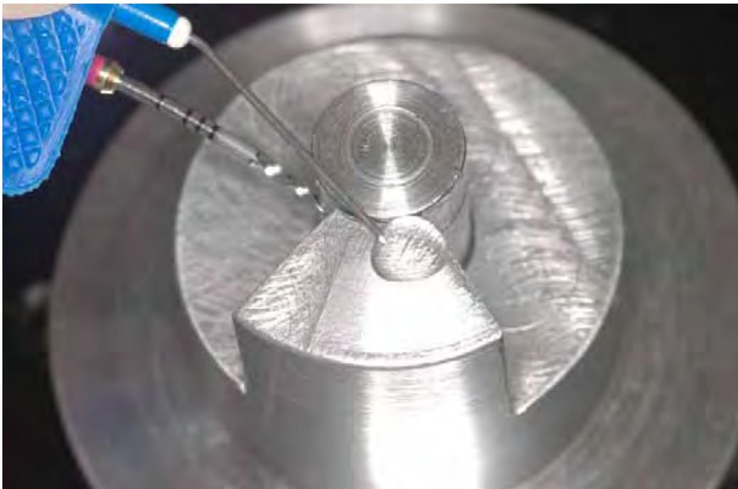
FIGURA 3 - Refrigeração do conjunto instrumento-canal artificial por meio de uma ponta de irrigação.
