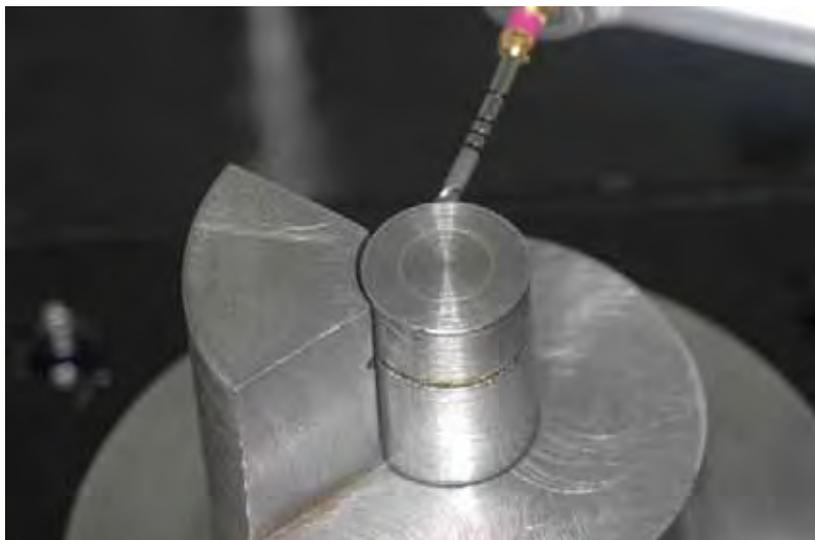
FIGURA 5 - Adaptação da parte ativa do instrumento nos sulcos confeccionados no canal simulado de aço inoxidável.
