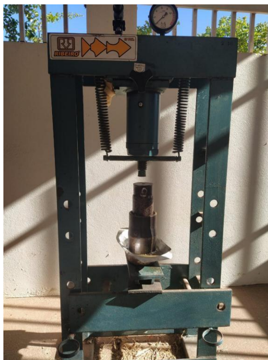
Figura 7- Extração do suco da silagem utilizando prensa hidráulica.
