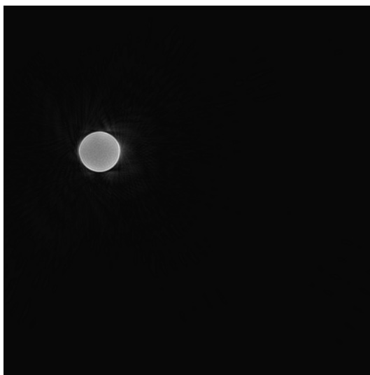
Figura 3.4 - Imagem do fantoma de modelo 76-907, para avaliação do sinal produzido pelo cilindro externo.
