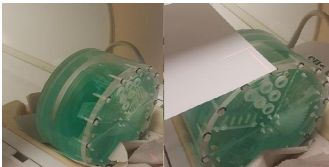
Figura 2.6 - Posicionamento e alinhamento do fantoma modelo 76-903 na bobina de cabeça.
