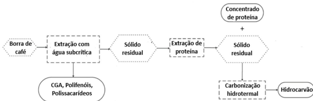
Figura 24 – Biorrefinaria de borra de café para produção de extrato bioativo, proteico e combustível sólido
