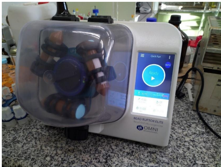
Figura 7 – Agitador homogeneizador Bead Ruptor Mill (OMNI, GA, EUA)
