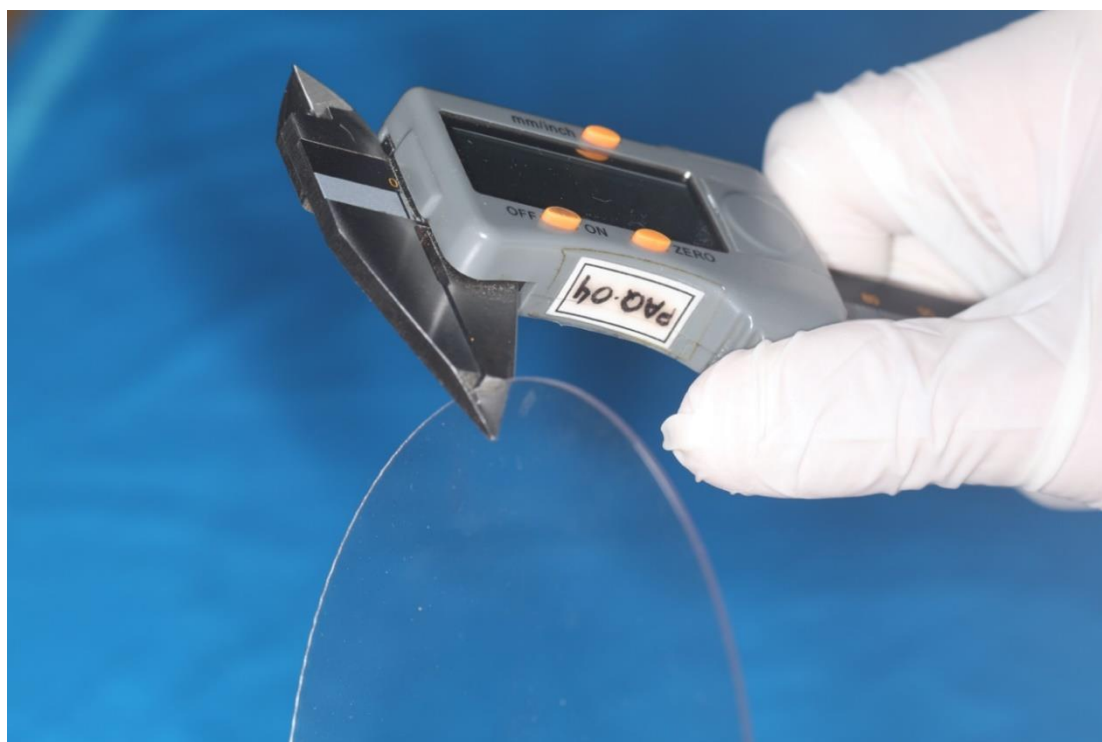
Figura 1 B - Conferência da espessura da placa de alinhador com paquímetro de precisão.
