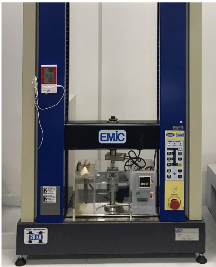
Figura 8- Máquina de ensaio universal EMIC empregada nos ensaios de deflexão das placas.
