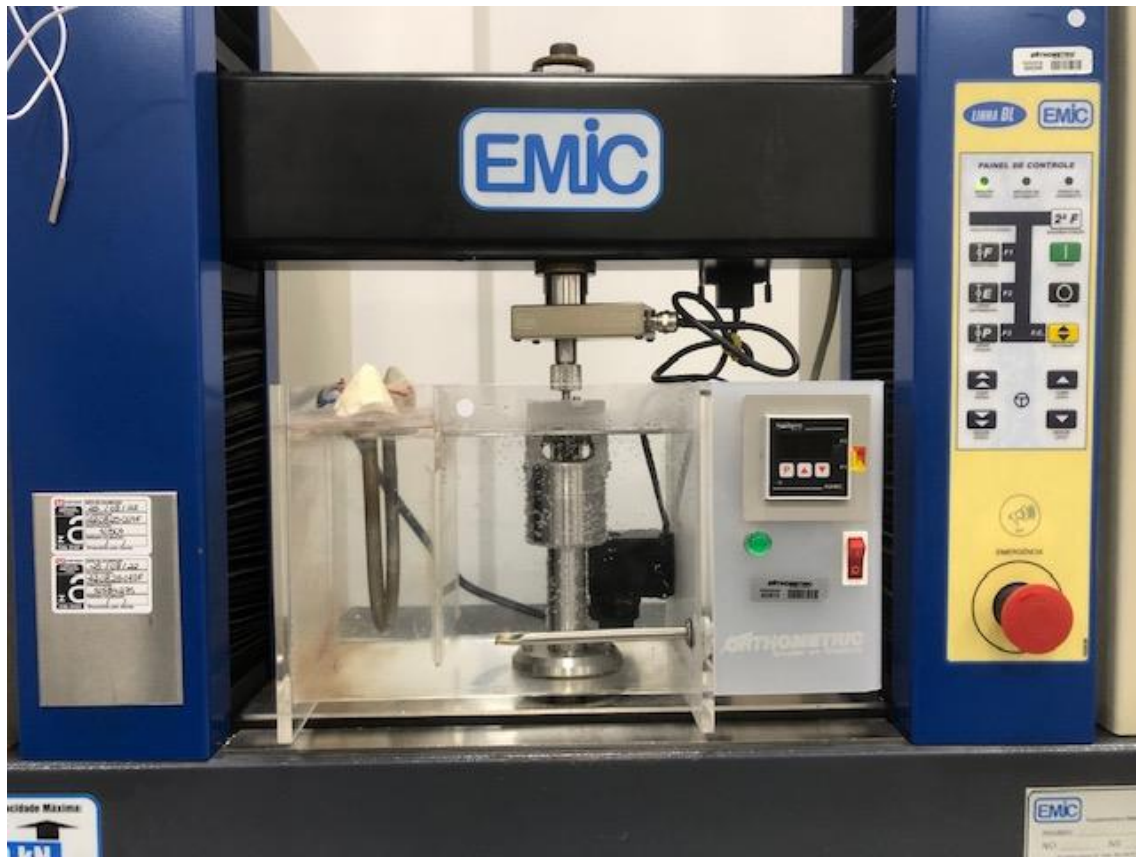
Figura 7- Cuba contendo água a 37° C para a realização do ensaio de 3 pontos. A plataforma de apoio encontra-se inserida na cuba.
