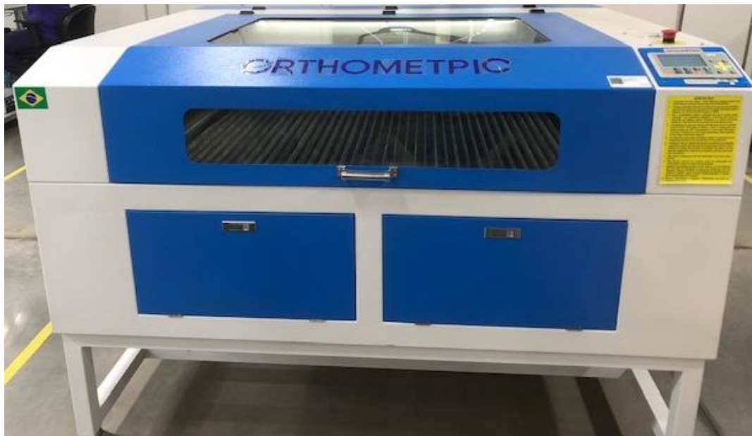
Figura 2 - Máquina de corte e gravação a laser CO 2 , modelo L1210.
