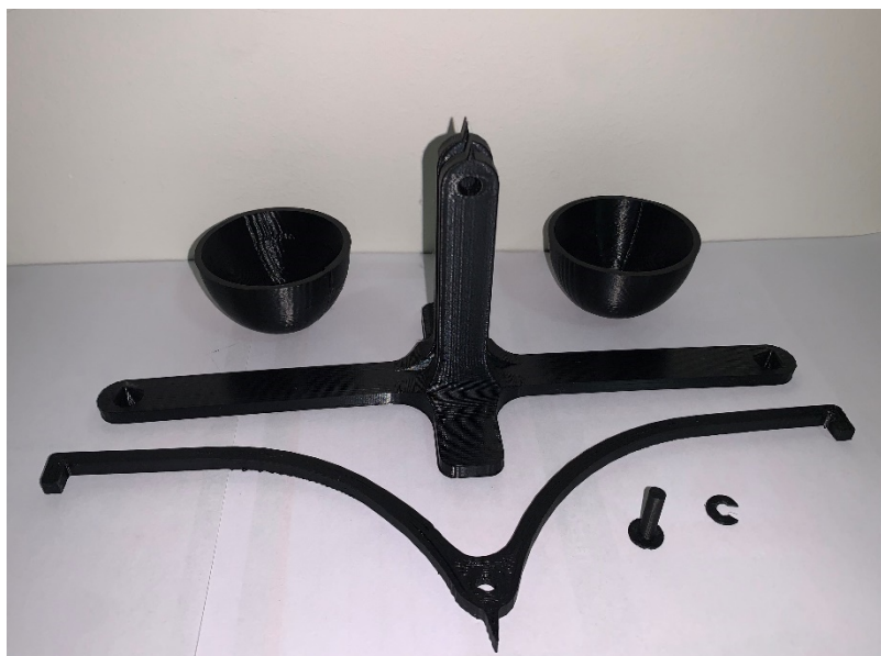
Figura 22 - Partes impressas em 3D que compõe o experimento da balança.
