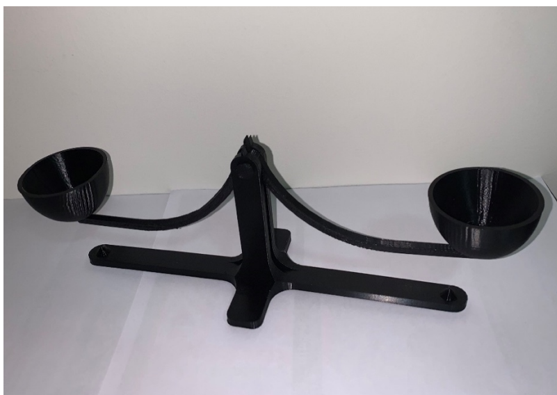
Figura 23 - Montagem completa do experimento da balança.
