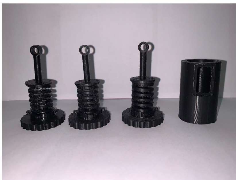
Figura 27 - Partes impressas em 3D que compõe o experimento das molas.
