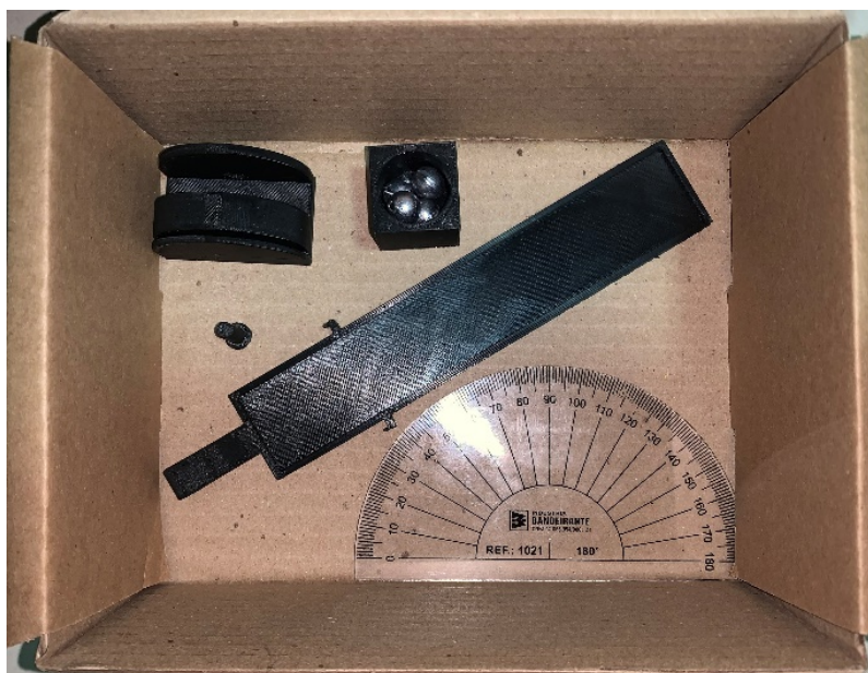
Figura 25 - Partes impressas em 3D que compõe o experimento da rampa.
