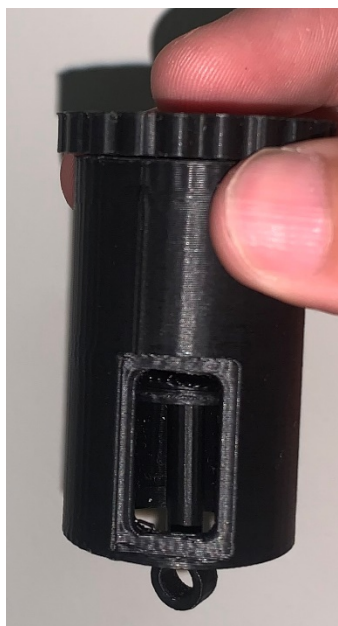
Figura 28 - Demonstração da montagem para o uso do experimento das molas.
