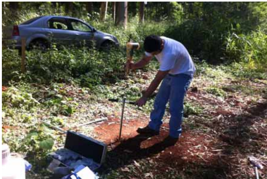
Figura 34: Coleta dos corpos-de-prova de solo utilizando o trado manual com ringholder acoplado.
