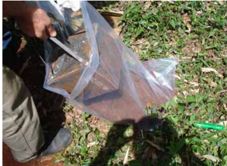
Figura 44: Homogeneização da amostra (amostra representativa de cada bloco).
