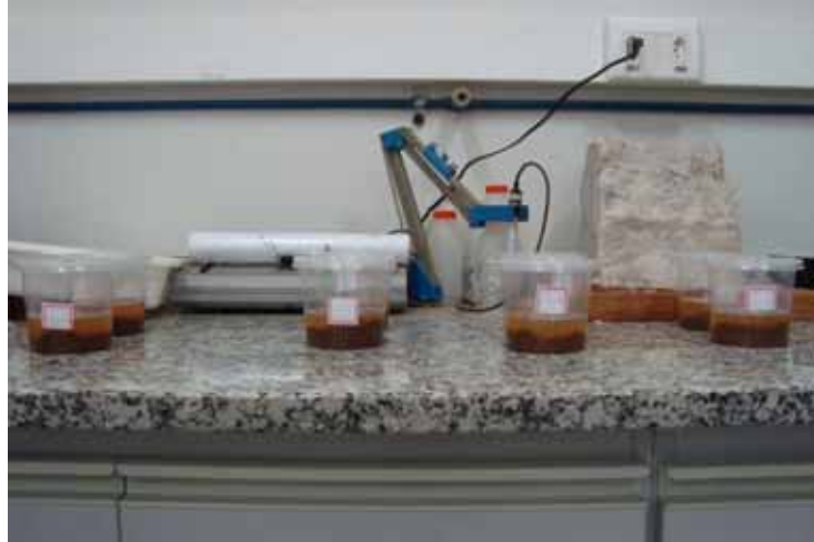
Figura 25: Amostras com defloculante.
