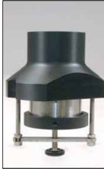
Figura 36: Cartucho contendo a cápsula anelar com o corpo-de-prova de solo (Fonte: www.eijkelkamp.com ).
