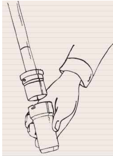
Figura 33: Ringholder (coletor de corpos-de-prova de solo) acoplado ao trado manual (Fonte: www.eijkelkamp.com ).
