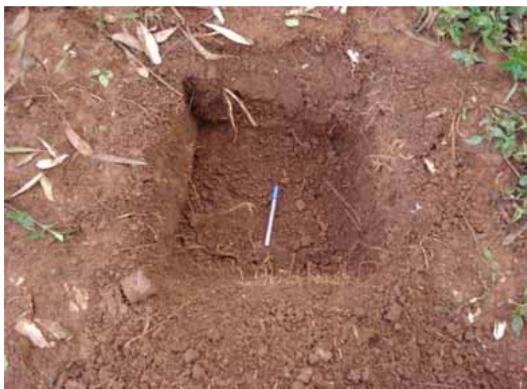
Figura 40: Trincheira onde foi realizado o derramamento do contaminante.
