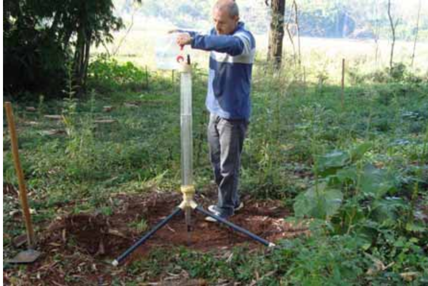
Figura 32: Ensaio de condutividade hidráulica in situ utilizando o Permeâmetro de Guelph.
