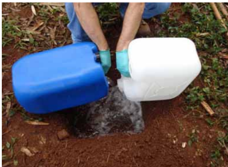
Figura 41: Derramamento dos 27 litros de contaminante realizado no dia 01/10/2013.
