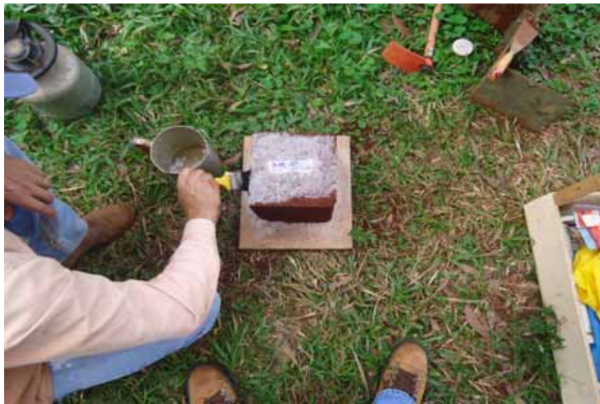
Figura 23: Impermeabilização da amostra indeformada.
