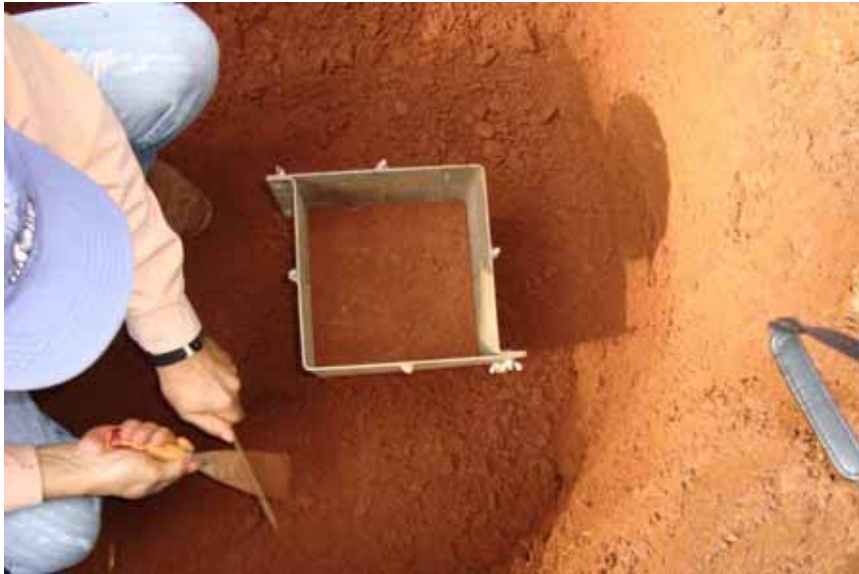
Figura 21: Coleta de amostra indeformada.
