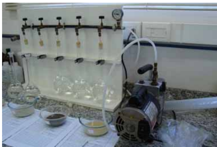
Figura 27: Desaeração das amostras.
