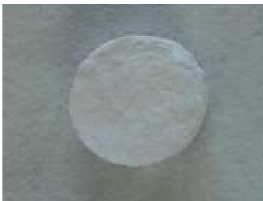
Figura 59 - Fotografia do disco de hidroxiapatita preparado com o molde de teflon. Fonte: Autor.
