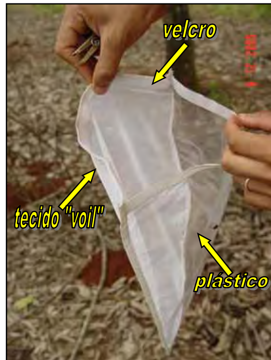
Figura 7. Envelope confeccionado com plástico, tecido “voil” e velcro.
