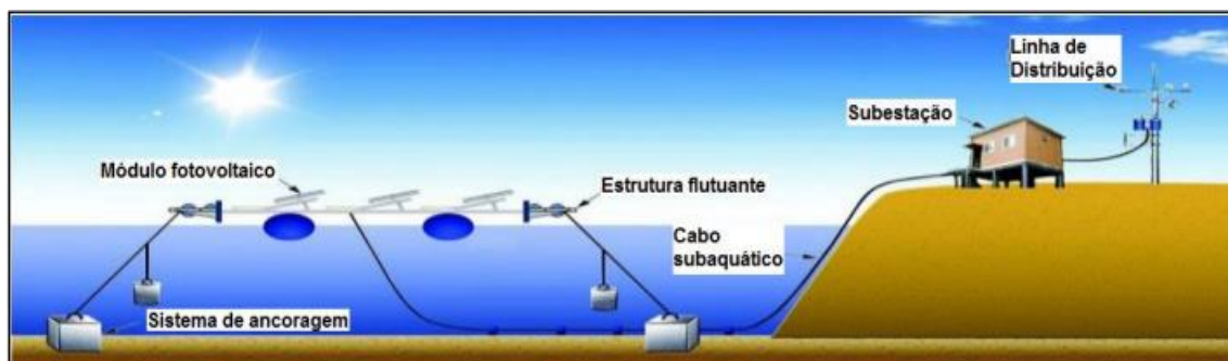
Figura 44 – Esquema geral solar e fotovoltaico flutuante
