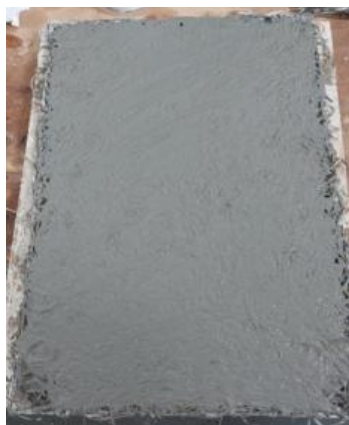
Figura 22 – Painel WWCB traço I confeccionado com camadas cimentícias externas
