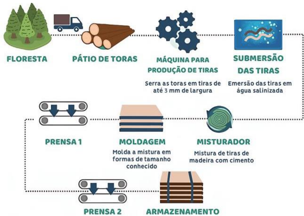
Figura 15 - Planta de produção simplificada de WWCB
