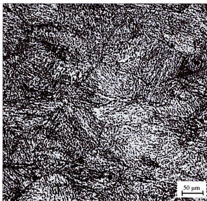
FIGURA 42 – Aspecto microestrutural do metal base (MB). Observa-se que a microestrutura do metal base permanece inalterada, visto que os níveis de temperatura alcançados não são suficientes para produzir alterações microestruturais.
