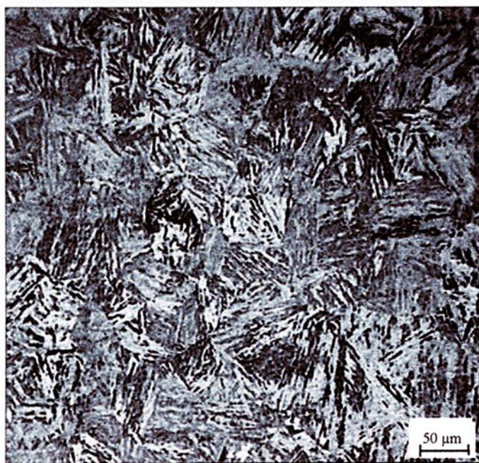
FIGURA 40 – Aspecto microestrutural da zona superaquecida ( ZTA_1 ), região adjacente a linha de fusão.
