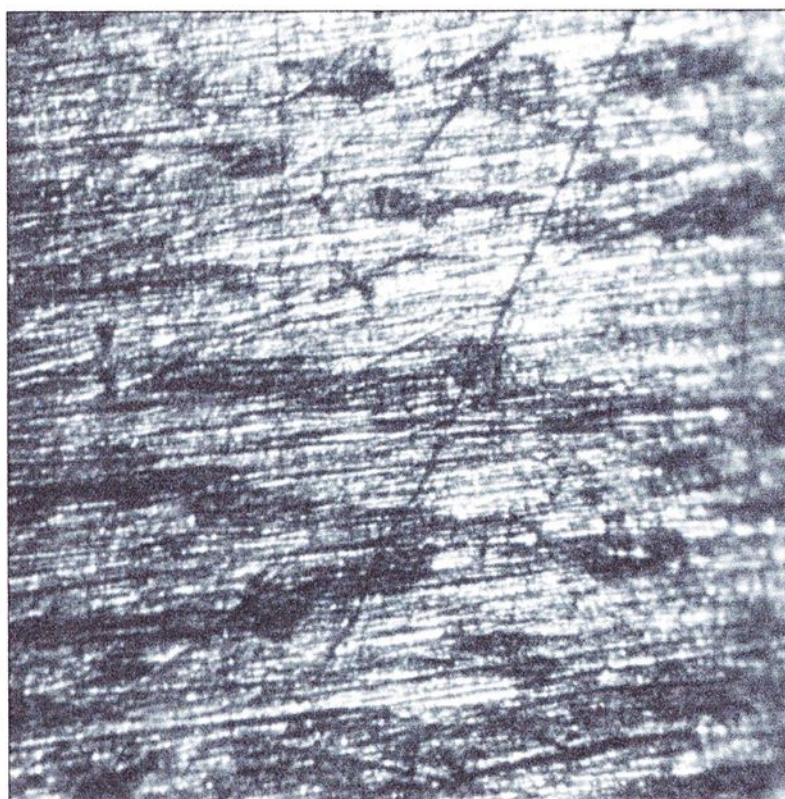
FIGURA 23 – Aumento 32x. Aspecto da superfície tracionada do corpo-de-prova isenta de microfissura.
