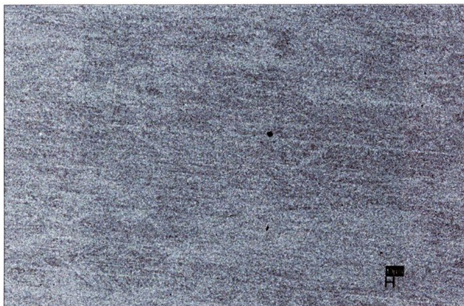
FIGURA 18 – Observa-se inclusões do tipo “E” nitreto de titânio.
