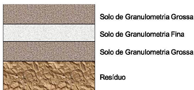
Figura 6: Sistema de cobertura por Barreira Capilar Dupla (Amorim, 2008 – adaptado)
