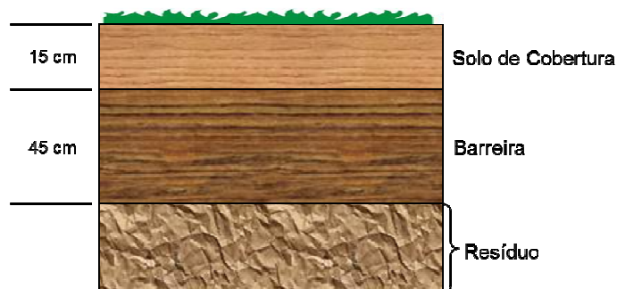
Figura 9: Cobertura final em aterros de resíduos sólidos urbanos (RSU) EUA (Dwyer, 2003)
