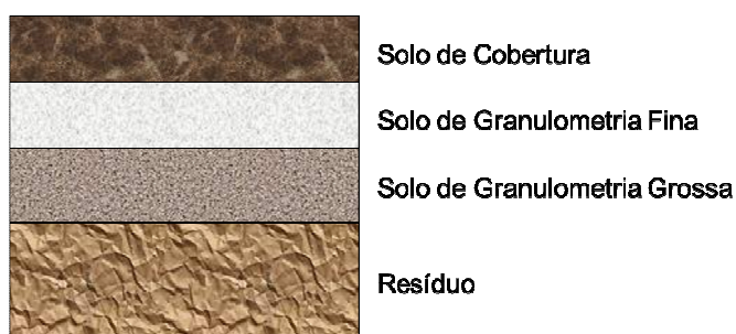
Figura 5: Sistema de Barreira Capilar (Boscov, 2008 – adaptado)
