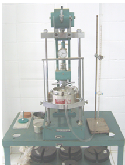
Figura 50: Ensaio de Permeabilidade
