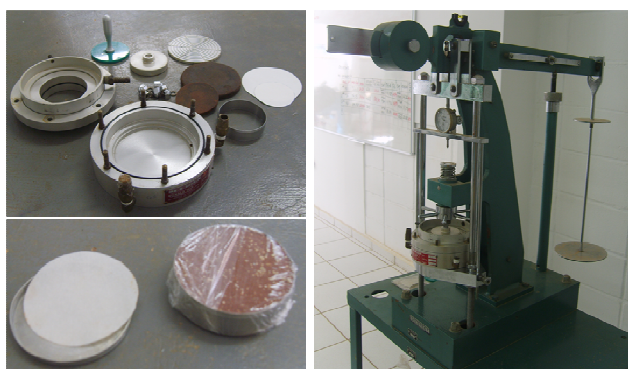
Figura 49: Aparelhagem usada no ensaio de compressão edométrica.
