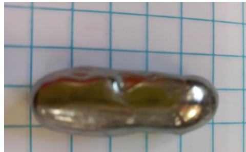
Figura 9 – Lingote fundido com composição Ti-20Ta-30Nb
