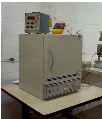
Figura 10: Sistema utilizado para medidas de expansão térmica.
