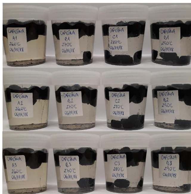
Figura 3.3 – Ensaio de adsorção da solução de cafeína 5,0 \mu\text{g L}^{-1} após 24 h, usando as amostras BG260C, BG270C, BG280C e BG290C. Fonte: Cottorello-Fonsêca (2019).
