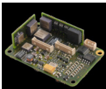
Figura 2.8 – Dispositivo de rastreamento inercial comercializado pela Xsens, composto por giroscópio, acelerômetro e magnetômetro. Fonte: (XSSENS, 2011).
