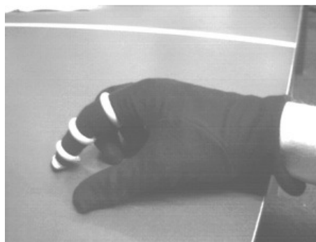
Figura 2.10 – Luva com marcadores óticos reflexivos. Fonte: (DORFMUELLER-UHAAS, K; SCHMALSTIEG, 2001).
