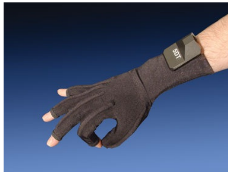
Figura 2.12 – Luva da 5DT com sensores de fibra ótica. Fonte: (FIFTH DIMENSION TECHNOLOGIES, 2011).
