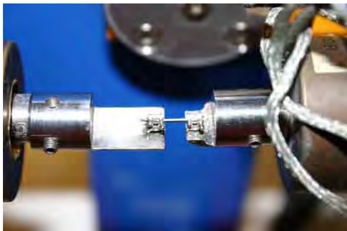
FIGURA 14 - Fio reto inserido de maneira passiva.
