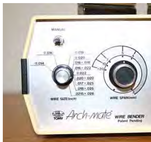
FIGURA 19 - Detalhe do painel da Arch-Mate tm .
