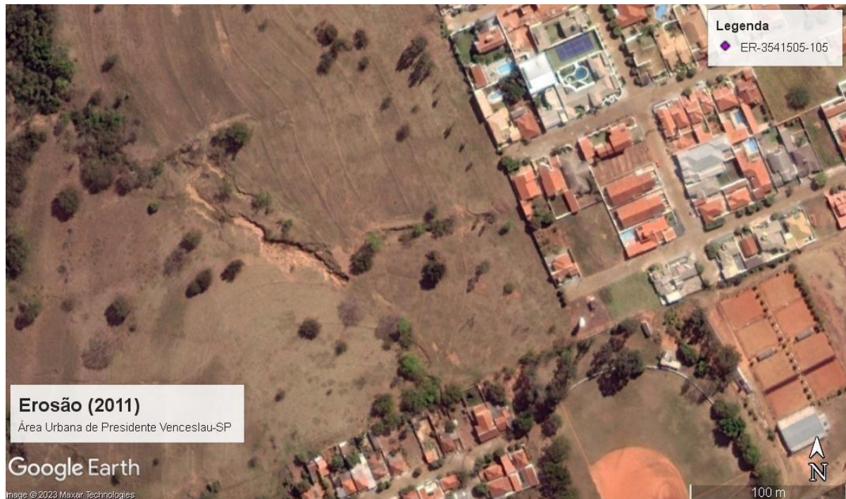
Figura 33 - Erosão urbana 1 em Presidente Venceslau-SP em 2011
