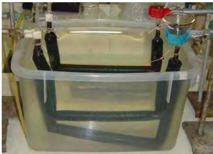
**Figura 6** – Sistema utilizado na diálise das substâncias húmicas extraídas de amostras de águas coletadas na Bacia do Rio Negro–AM.
