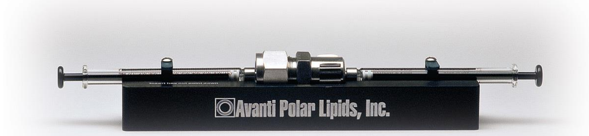
Figura 2: Mini extrusor (Avanti Polar Lipids) utilizado para a confecção das vesículas unilamelares.
