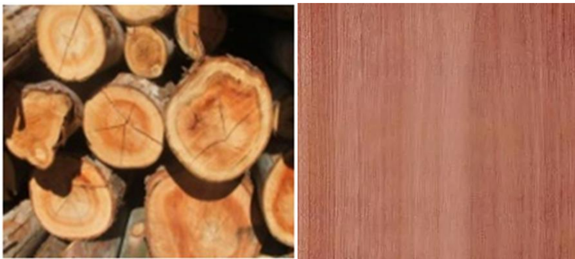
Figura 4 – Madeira serrada e face tangencial da madeira de Eucalyptus grandis .
