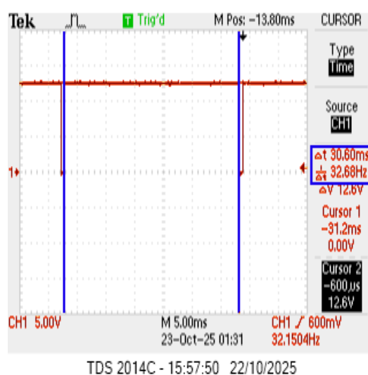
(b) Multivibrador configurado na maior frequência possível.
