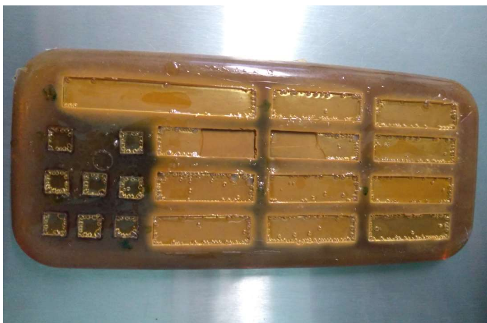
Figura 44 - Corpos de prova em seu estado vítreo para o sistema PMMA com 2,0 %m/m de iniciador PBO, com elevada concentração de bolhas.
