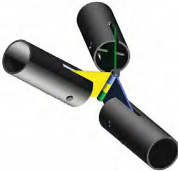
Figura 40 – Modelagem em computador mostrando que as placas giram livremente em torno do eixo da dobradiça e os tubos giram livremente em torno do parafuso de articulação que trespassa a placa Fonte: DINIZ, 2006.
