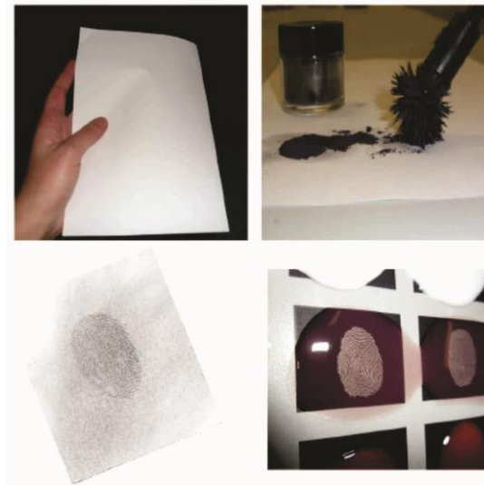
Figura 2.14 – Processo de criação de um spoof de impressão digital pelo modo não cooperativo. Adaptado de (GHIANI et al., 2013).
