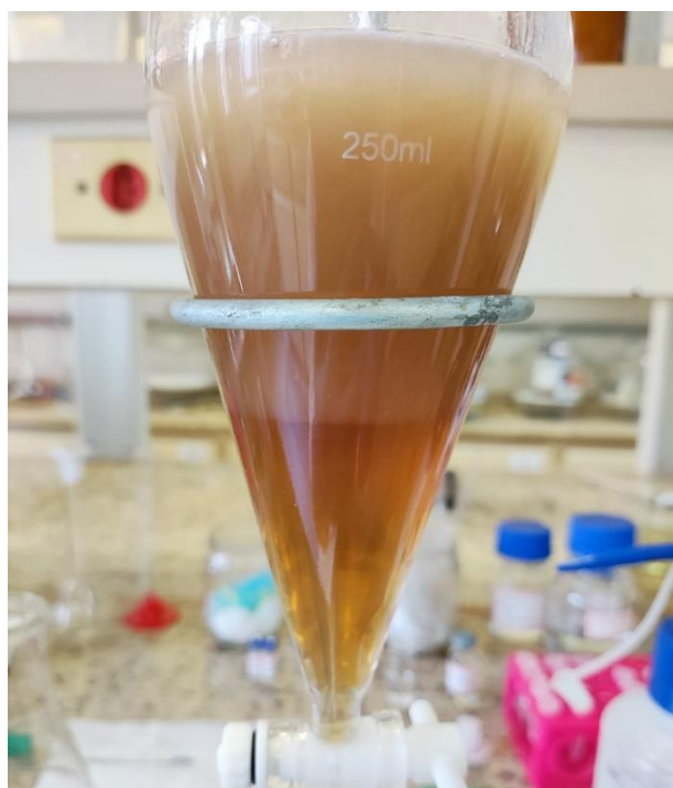
Figura 33- Funil de separação com a emulsão e camada de “gel” durante a extração da reação de oxidação do EB usando 0,34g de AaeUPO
