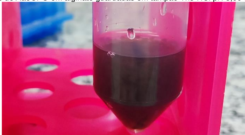
Figura 37- Esferas de AaeUPO em alginato guardadas em tampão Tris-HCl pH 8,00 50 mmol L -1
