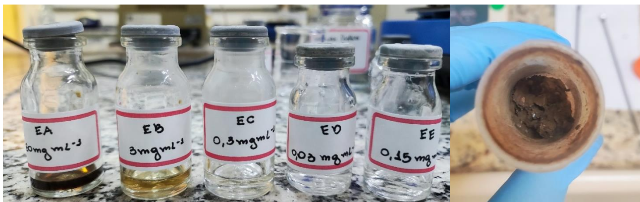
Figura 17- Coloração das enzimas a) Soluções enzimáticas e suas diferentes colorações; b) Enzima AaeUPO em pó liofilizado do extrato enzimático
