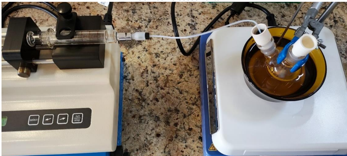
Figura 26- Sistema de adição de peróxido com bomba de seringa para a reação de oxidação com MeCN como cossolvente
