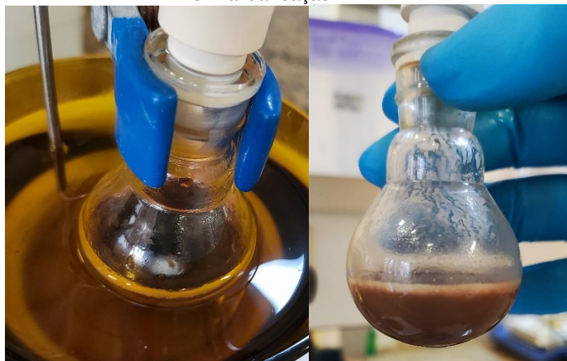
Figura 31- Balão de reação da oxidação do EB usando 0,34 g de AaeUPO a) no início da reação b) no final da reação
