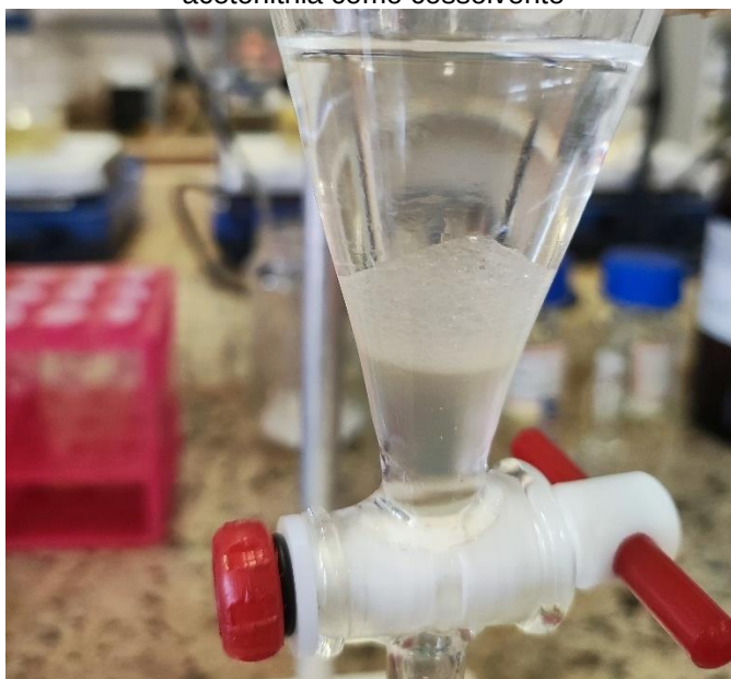
Figura 29- Emulsão no funil de separação da reação de oxidação do EB usando 70 mg de AaeUPO e acetonitrila como cossolvente
