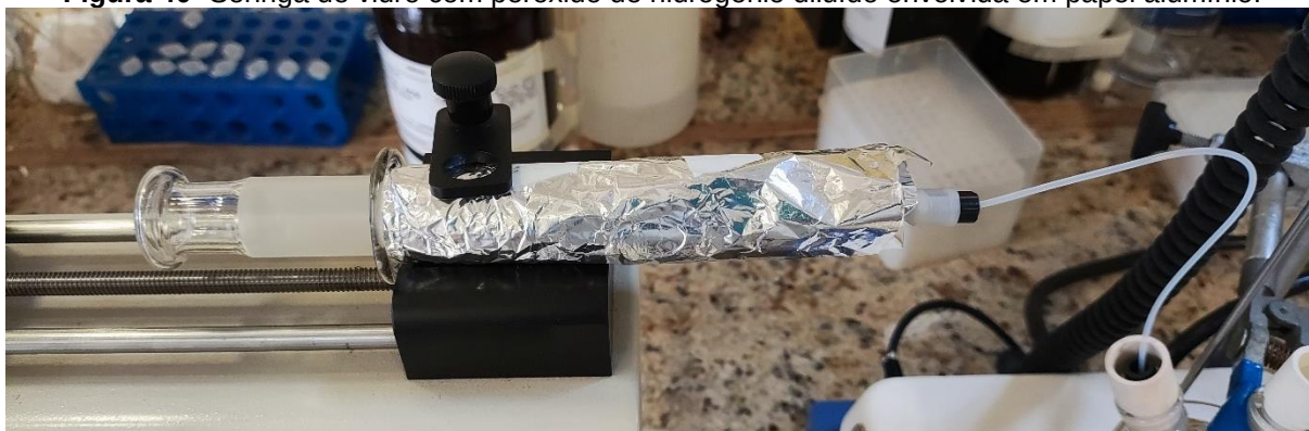
Figura 40- Seringa de vidro com peróxido de hidrogênio diluído envolvida em papel alumínio.
