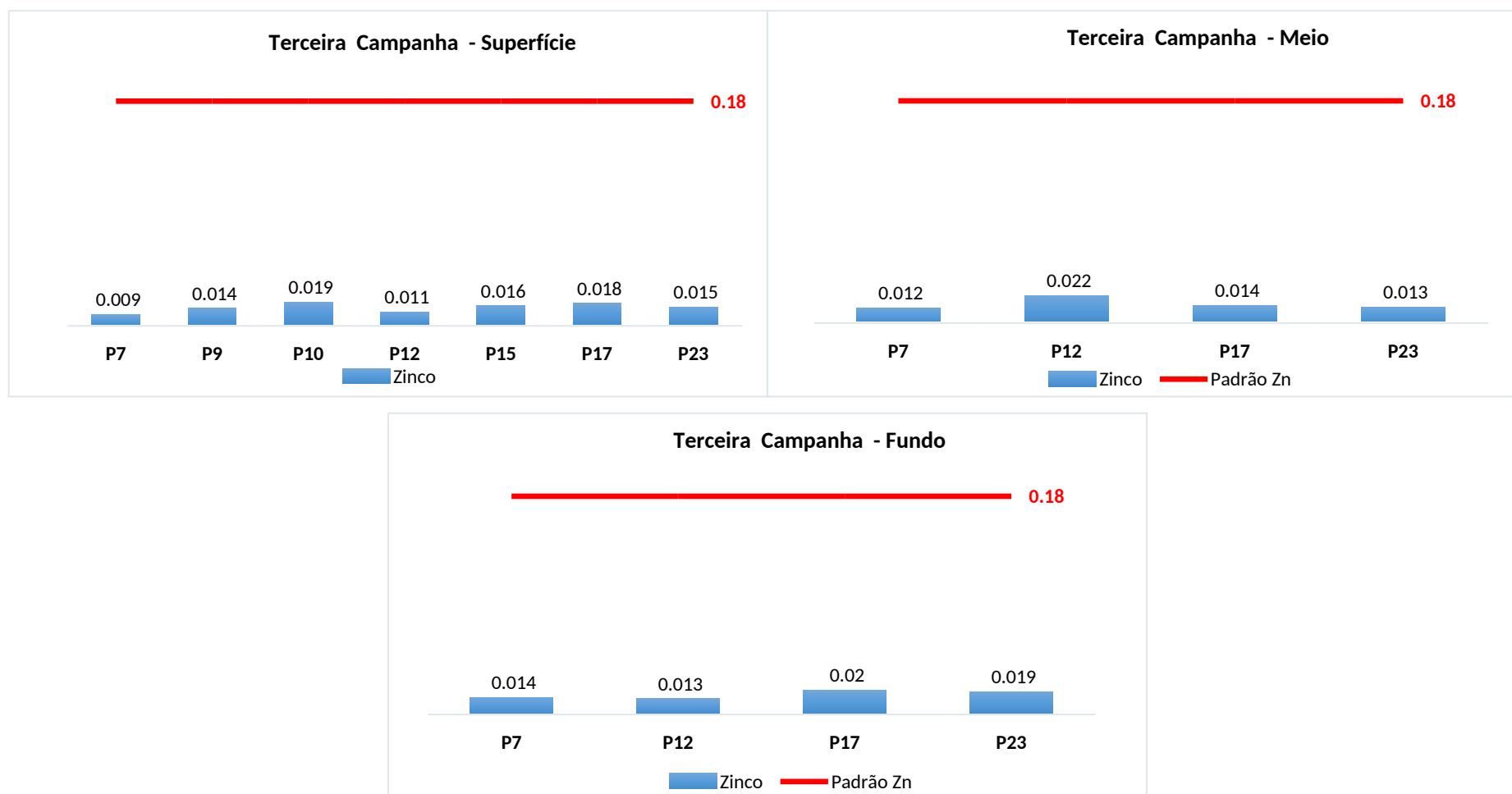
Figura 22: Concentrações de zinco detectadas na terceira campanha, nos perfis (mg. L -1 )
