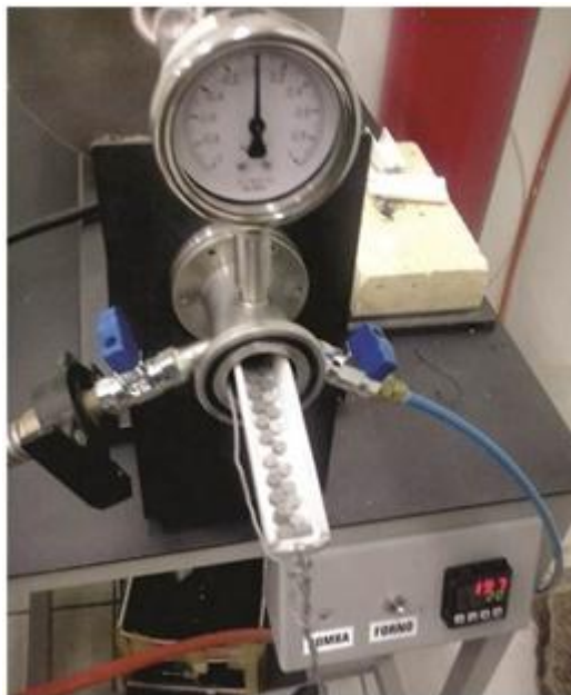
Figura 20 - Formo tubular empregado para tratamento térmico dos scaffolds de Ti6Al4V.
