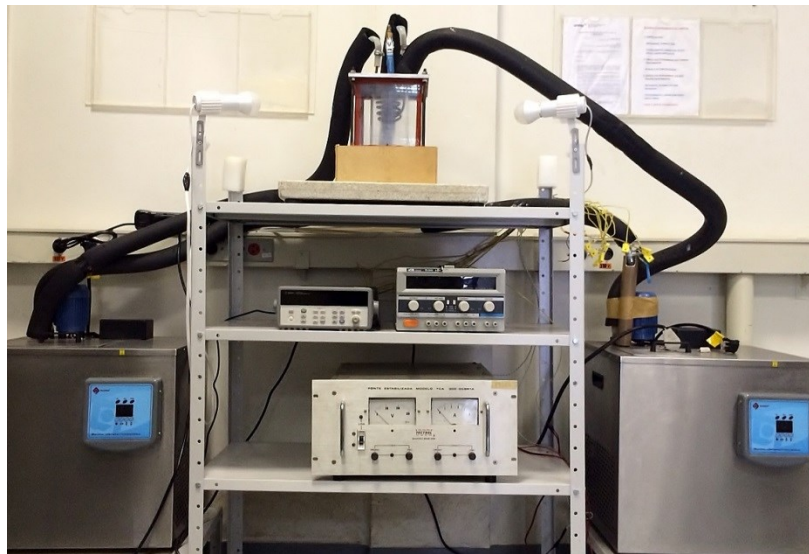
Figura 26 - Bancada experimental para o estudo da ebulição nucleada de nanofluidos.
