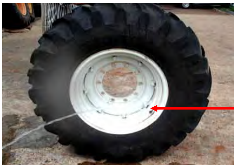
Figura 6 - Adição de 37,5% de água no pneu
