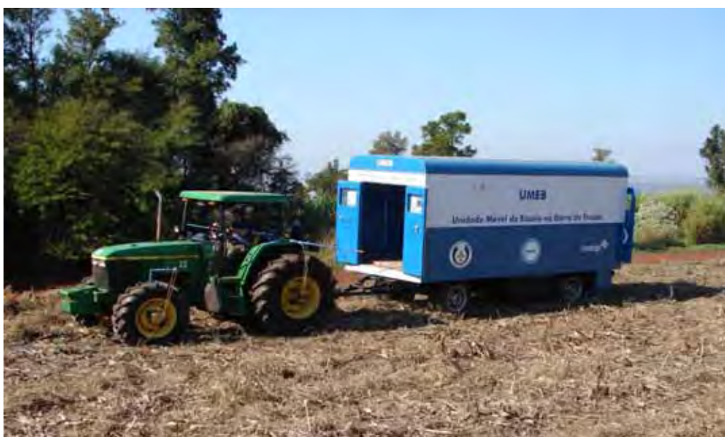
Figura 10 - Conjunto trator e Unidade Móvel para Ensaio na Barra de Tração – UMEB.
