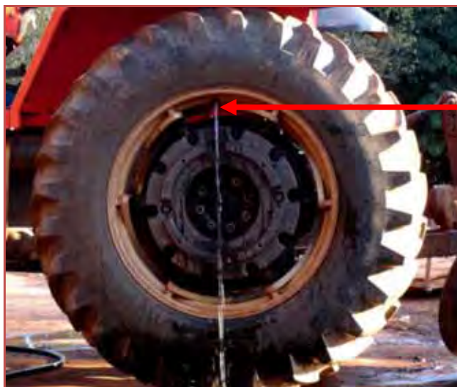
Figura 7 - Adição de 75% de água no pneu
