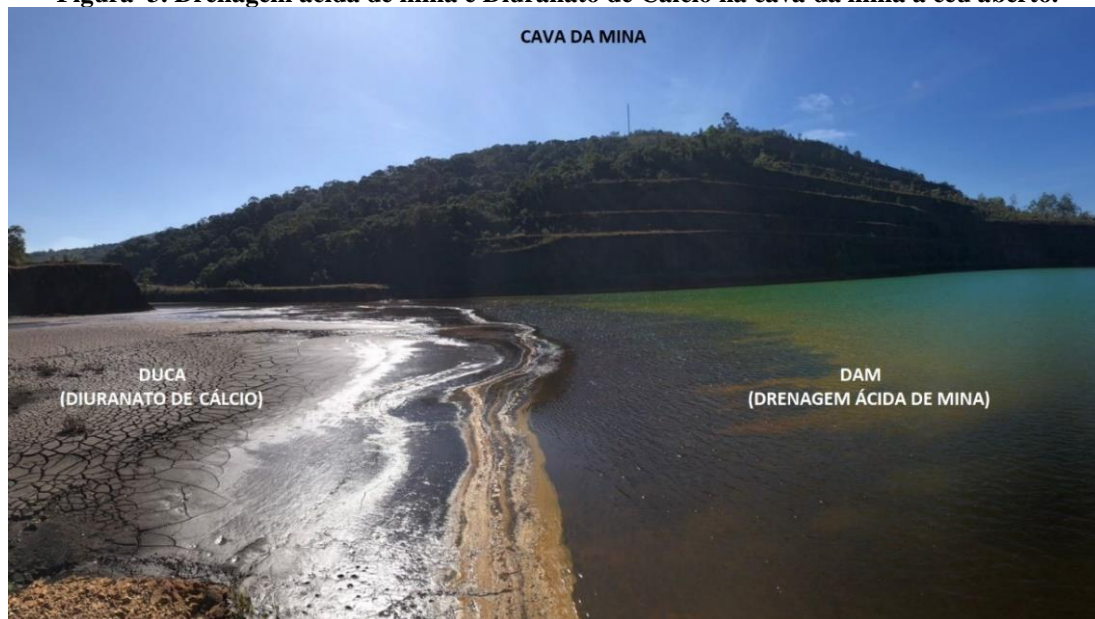
Figura 3. Drenagem ácida de mina e Diuranato de Cálcio na cava da mina à céu aberto.
