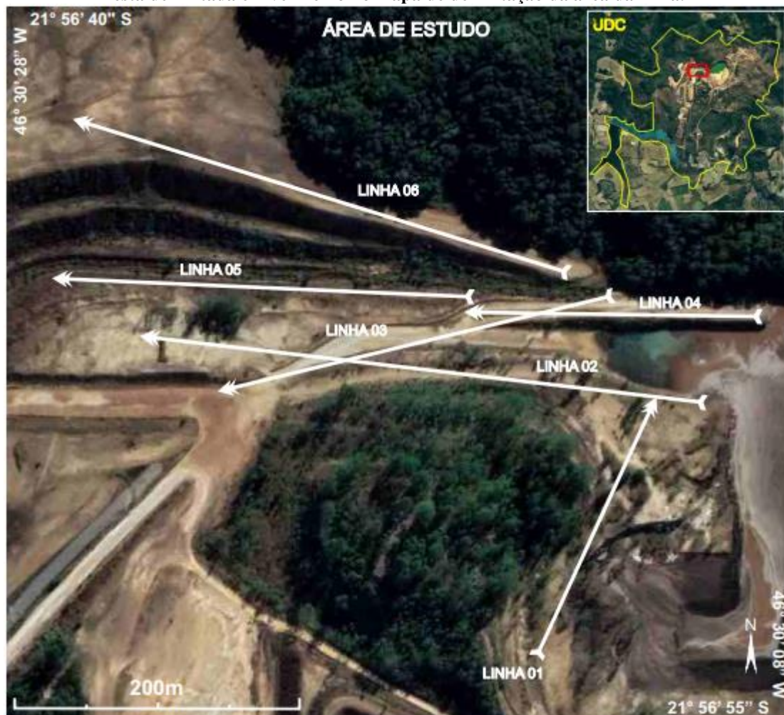
Figura 20. Vista geral da disposição de linhas de aquisição dos dados geoeletricos. A área de estudo está delimitada em vermelho no mapa de delimitação da área da mina.
