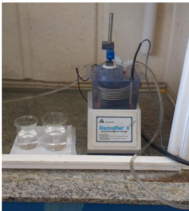
Figura 6 – Cuba eletrolítica e aparelho utilizados para o eletropolimento das amostras
