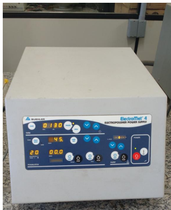
Figura 6 – Cuba eletrolítica e aparelho utilizados para o eletropolimento das amostras
