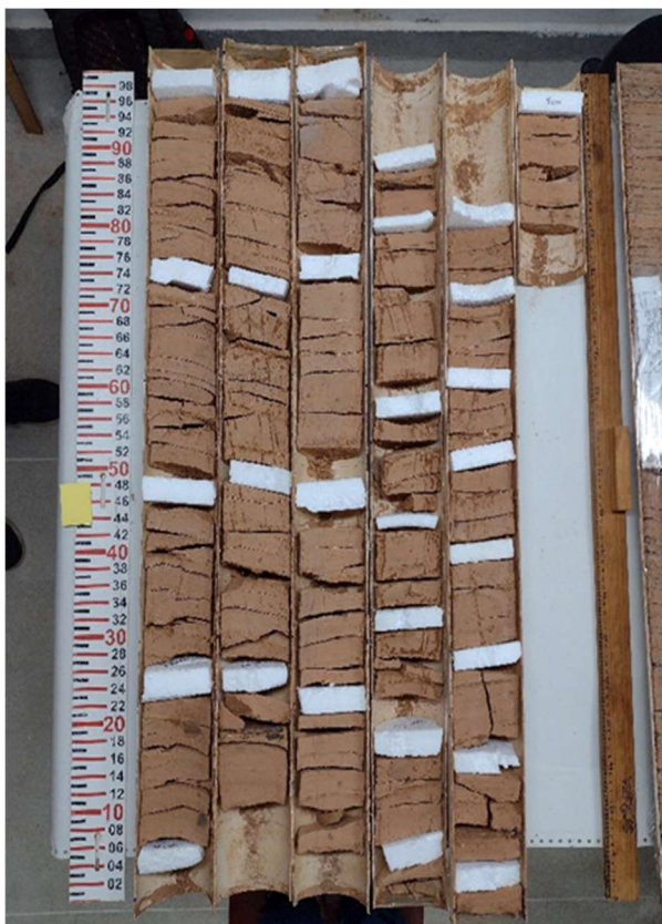
Fig. 7 Exemplar de um testemunho não definido extraído pelo método de amostragem à pistão ( piston coring ) dentro do conjunto de testemunhos do Sistema de Cânions Watu, disponibilizado pela Petrobras.
