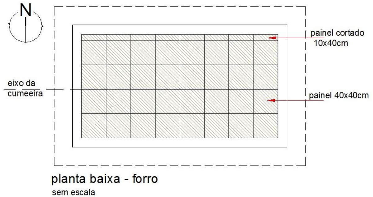
Figura 30: Planta baixa de forro.
