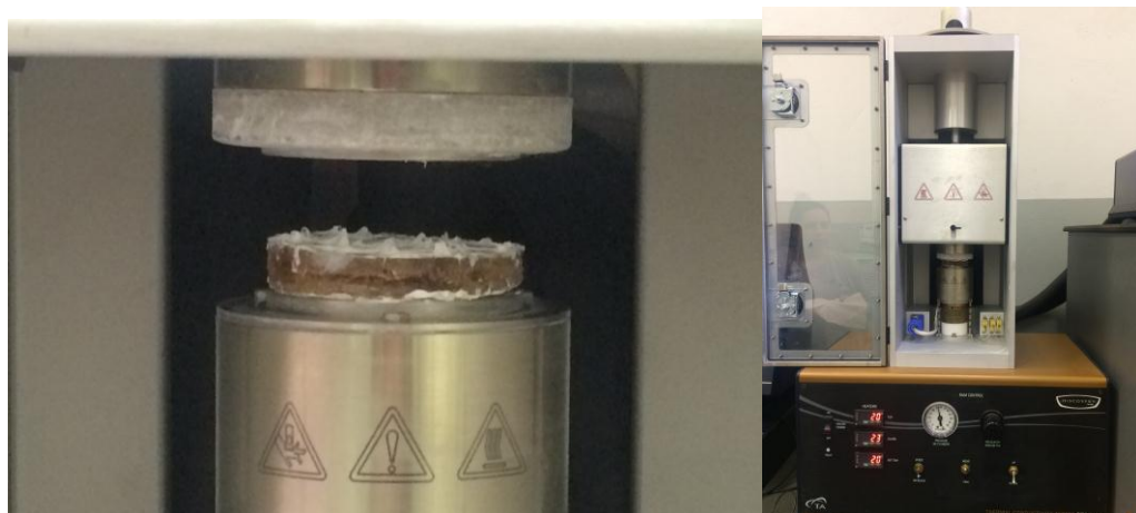
Figura 25:a) Corpo de prova no equipamento de ensaio, com pasta térmica; b) Equipamento DTC 300 para transmitância térmica.
