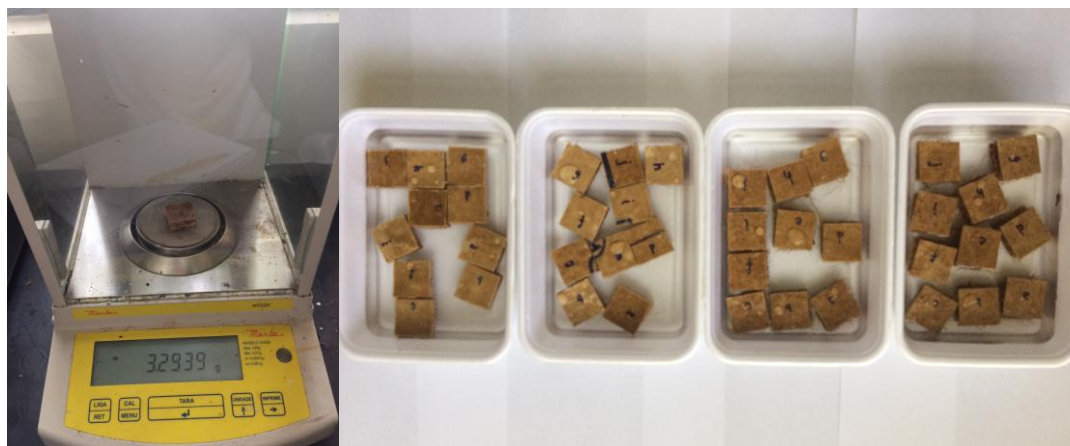
Figura 20: a) Corpos de prova submersos em água destilada; b) Pesagem inicial do corpo de prova.
