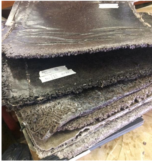
Figura 37: Painéis irregulares com FS+PP+CA.
