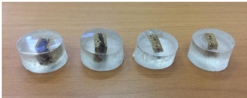
Figura 27: Embutimento das amostras.
