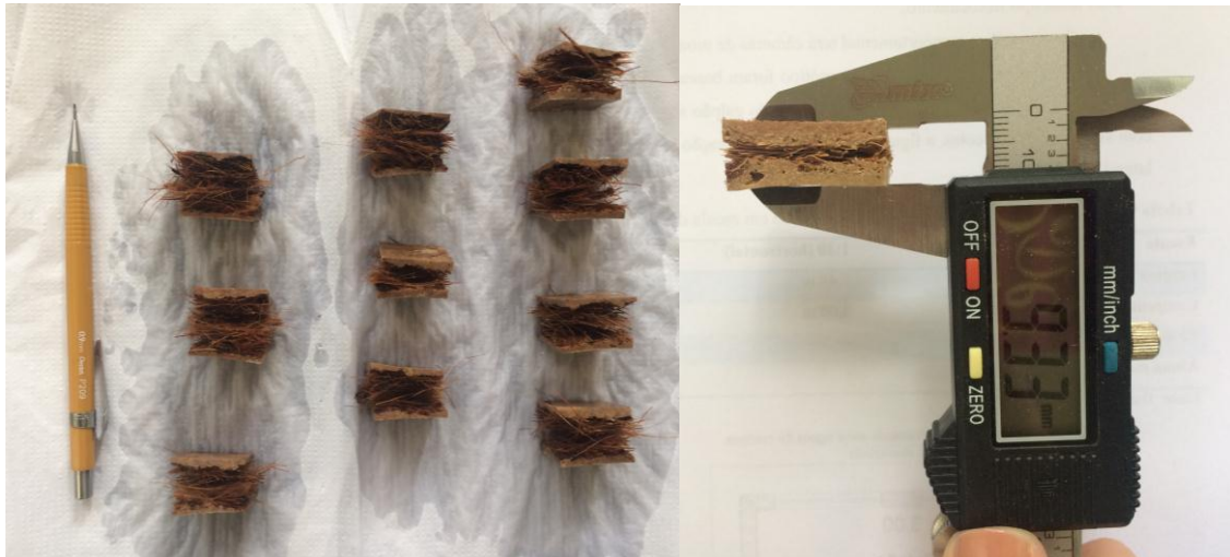
Figura 21: a) Corpos de prova em secagem superficial; b) Aferição do corpo de prova.
