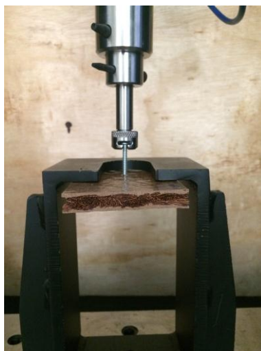
Figura 24: Ensaio arranchamento de parafuso de superfície.
