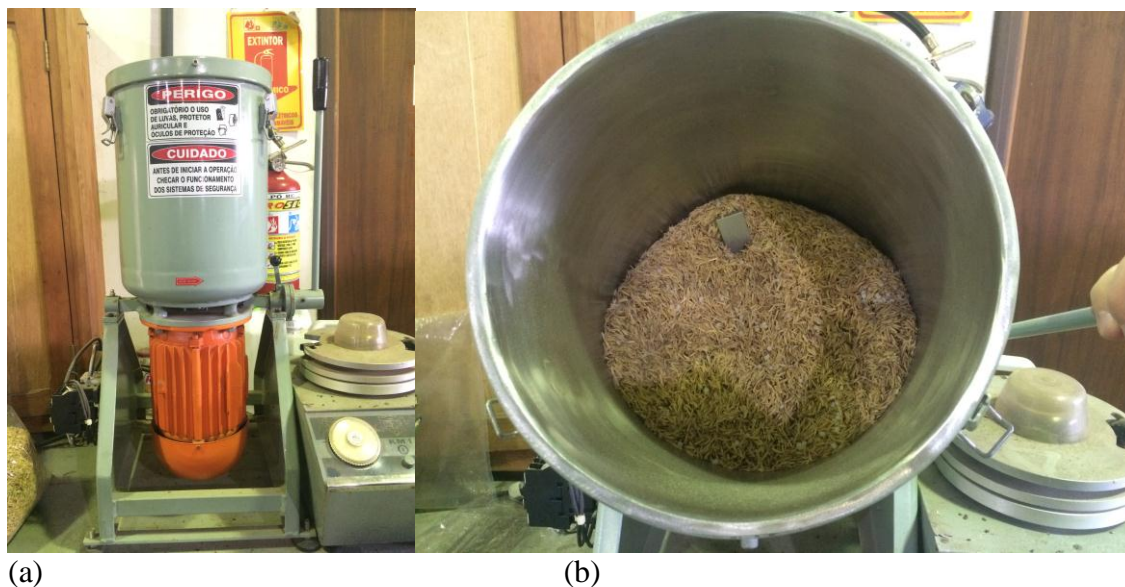
Figura 11: a) Homogeinizador; b) Casca de arroz e polipileno no misturador.
