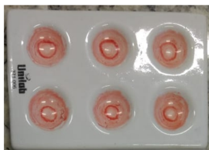
Figura 5 – Placa de porcelana com resíduo sólido avermelhado obtido após a reação entre cafeína (75 mg L -1 ) e KBrO 3 em meio ácido (HCl 37 %) ocorrer.
