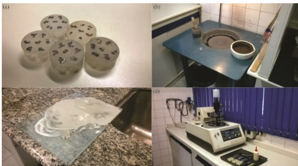
Figura 27 – (a) Discos, (b) politriz de bancada, (c) placa de vidro e (d) politriz automática
