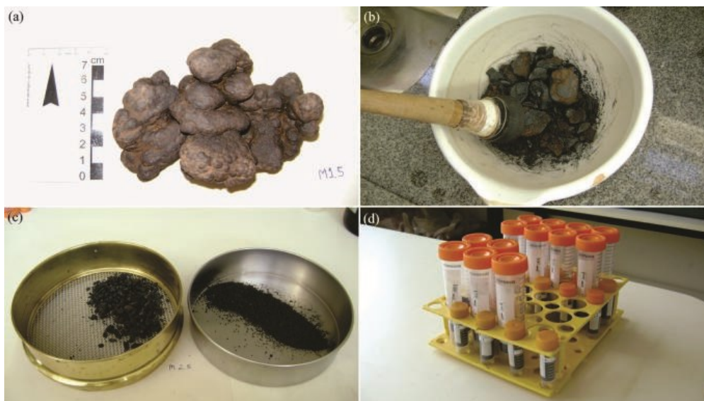
Figura 21 – (a) registro, (b) moagem, (c) seleção granulométrica e (d) acondicionamento
