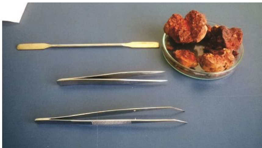
Figura 22 – Pré-seleção dos óxidos e óxidos de Fe com pinças e espátulas metálicas
