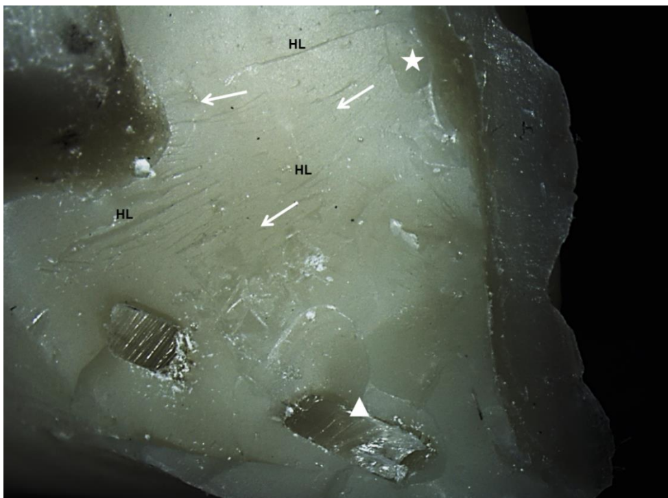
Figura 30 – Imagem da superfície de fratura da prótese adesiva posterior com reforço, na região de pântico e conector do molar
