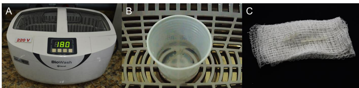
Figura 15 – Limpeza do reforço de nylon
